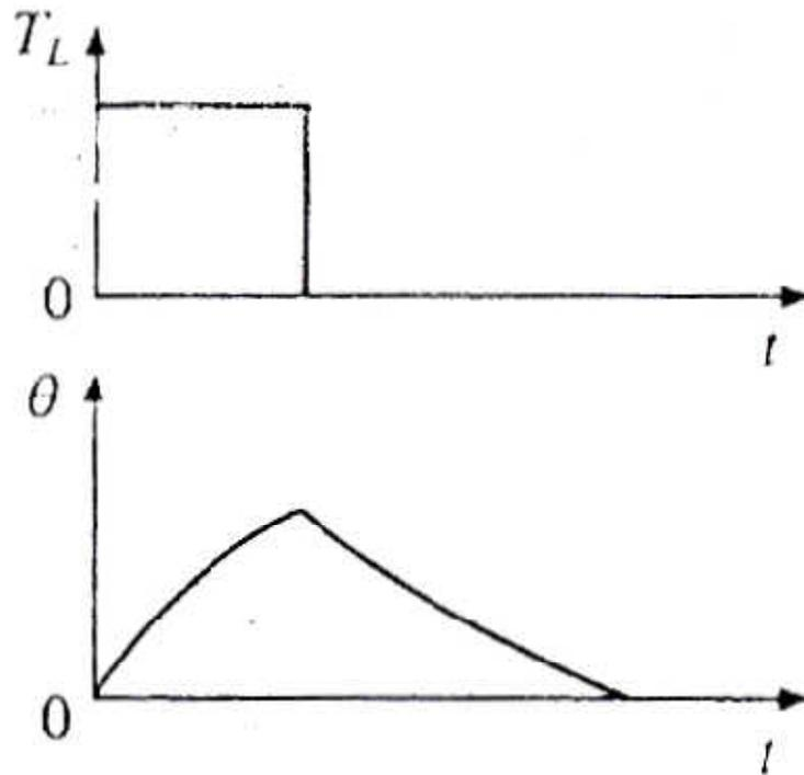
Fig. 5.3. Motor load diagram
