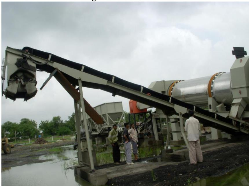
Fig. Load Out Conveyor
