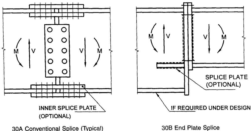
FIG. 30 BEAM SPLICES
